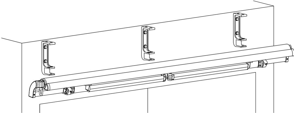
Compruebe que el toldo se ha instalado completamente recto con la ayuda de un nivel en la barra delantera.
